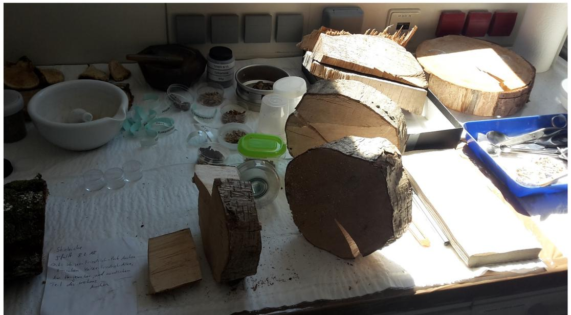
Abbildung 2: Getrocknete Baumscheiben im Labor vor der Zerteilung in Würfel zur Messung. (Quelle: Selbst erstellt)
