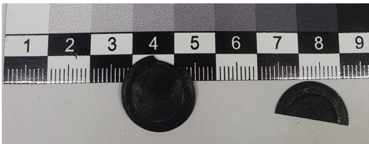
**Abbildung 13:** Abgeschiedenes Rhenium auf PLA #3 (370-380 mA, 20 min) und #4 (380 mA, 120 min).
