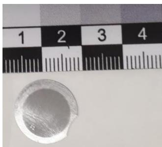
**Abbildung 27:** Abgeschiedenes Technetium auf Aluminium (10 mA, 4,75 h).
