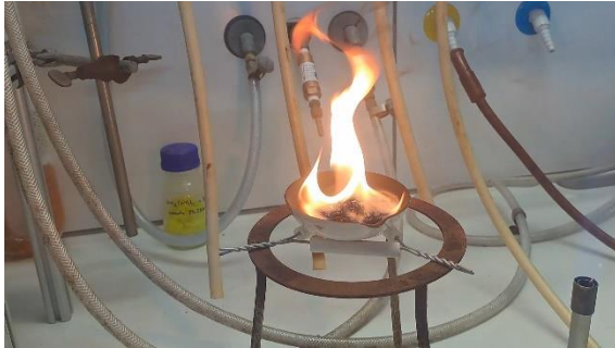
Abb. 1 Veraschung von 6 Paranüssen im Abzug
