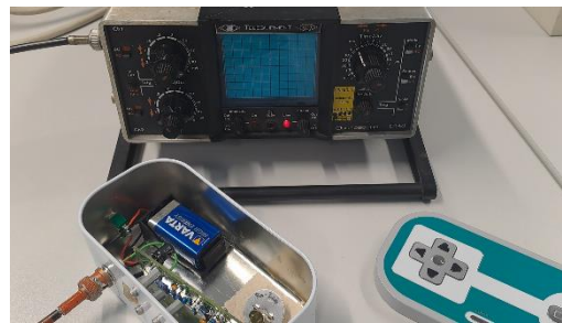
Abb. 6 Alpha-Spektrometer mit einem [Ra-226] Radium Präparat an einem analogen Oszilloskop
