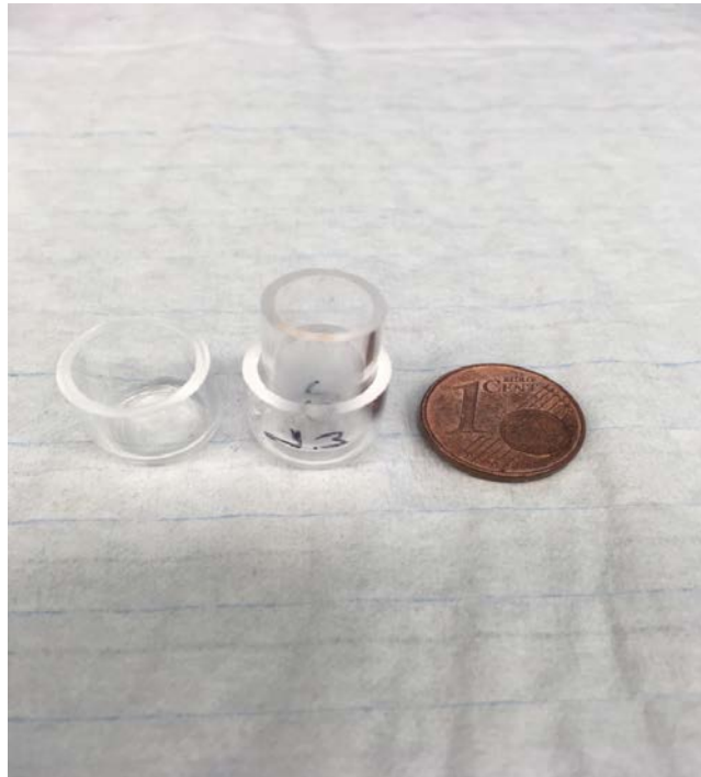
Abbildung 10: Quarztiegel mit Glührückstand
