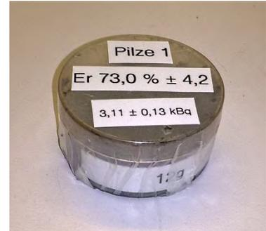
Abbildung 11 - Probenbehälter Pilz
