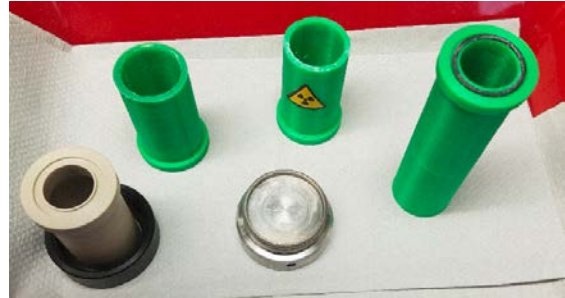
Abbildung 3: Ausgedruckte grüne Elektrolysezellen mit Vorbild (links).
