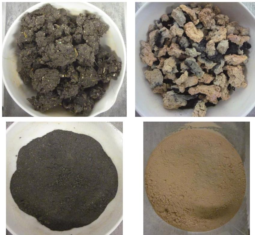
Abb. 5 Klärschlamm in den verschiedenen Aufarbeitungsschritten: getrockneter Klärschlamm, nach erstem Veraschungsschritt, nach erstem Veraschungsschritt (gemörsert), Endprodukt nach zweiter Veraschung (v.l.).
