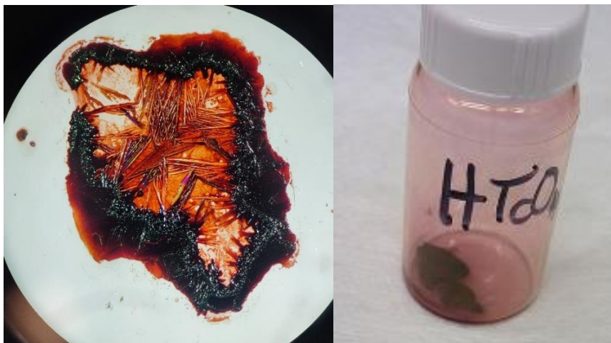
Abbildung 2: Links: Foto einer Probe mit Überschuss an \text{HTcO}_4 unter dem Mikroskop mit polarisiertem Licht. Rechts: Verbleibender Feststoff nach kompletter Evaporation des Solvenz einer wässrigen \text{HTcO}_4 -Lösung. [20]
